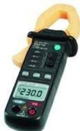
Assurez vous que la pince peut lire de 0 à 40 A. La cellule est conçue pour fonctionner à 12 A DC sans risque de surchauffe. Si vous avez un ampérage plus élevé avec un réservoir plein (maxi :70%), vous avez trop d'électrolyte dans le système. Il faut vider l'eau (eau + électrolyte) du réservoir et le remplir à nouveau avec de l'eau déminéralisée seule.
