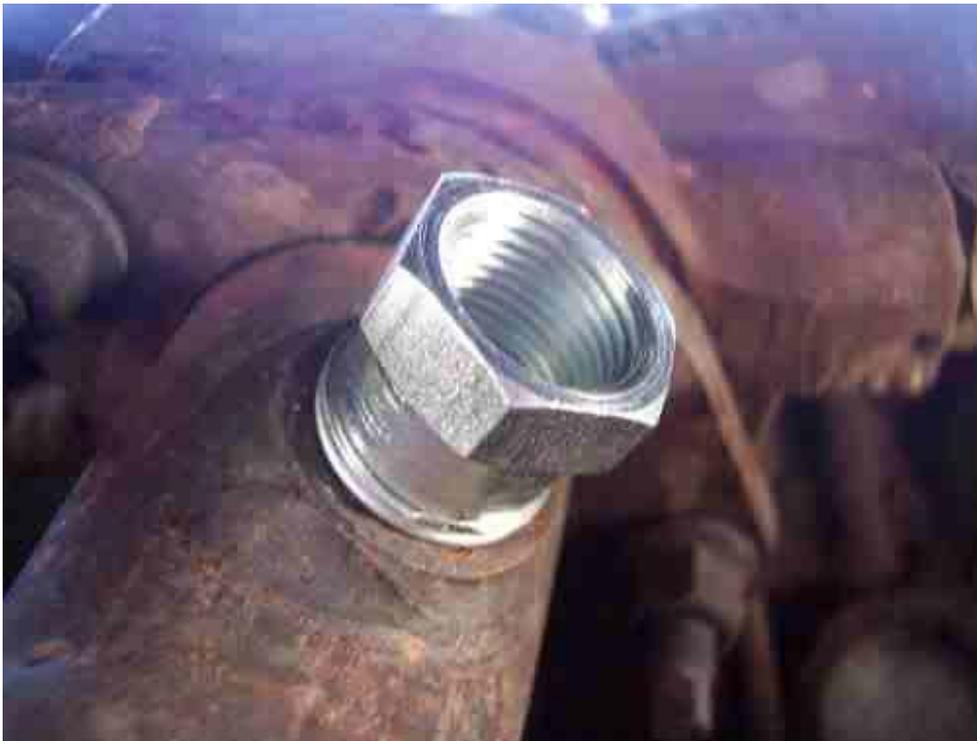
Visser le réhausseur dans l'échappement à la place de la sonde. Serrer à 50 Nm (37 lb-pi) maximum, puis posez la sonde sur le réhausseur. Si vous n'avez pas de clé dynamométrique, serrer sans bloquer, puis visser la sonde sur le réhausseur de la même manière.
