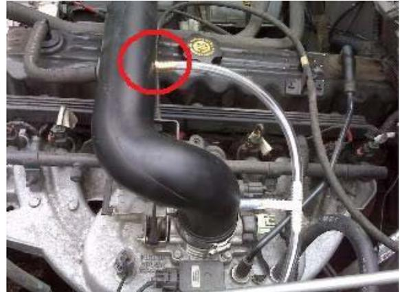
Démonter la durite d'air et percer un trou de 8 mm à proximité du collecteur d'admission. S'assurer qu'aucun copeau de perçage n'est resté dans la durite, et insérer le raccord haute pression avec de la colle ou du ruban téflon, puis serrer. Connectez ensuite le tuyau haute pression.
