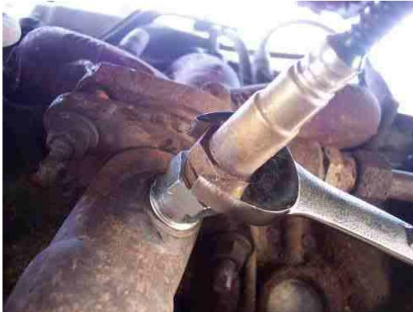
Note: Apporter le plus grand soin lors de la manipulation de sondes pour éviter tous dommages. Ne pas toucher, voire contaminer la sonde ou l'un de ses composants sous peine d'entraîner un mauvais fonctionnement de la sonde.
